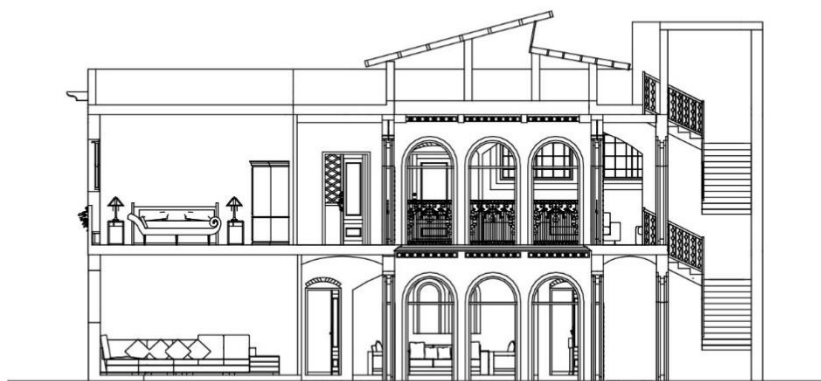
قطاع B-B مقياس الرسم 1:100
